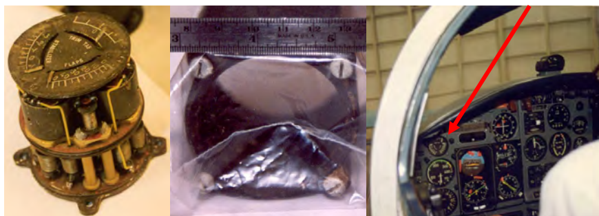
Fig. 4 – Indicatore triplo con il suo contenitore e le viti in acciaio inox e la sua posizione sul cruscotto. Foto dell'autore.
