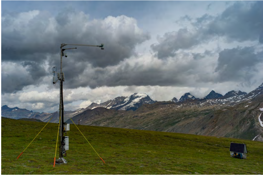
Fig. 1 – La torre di Eddy Covariance a circa 2700 metri di altitudine nelle praterie d'alta quota del Nivolet, nel Parco Nazionale Gran Paradiso. Questo strumento misura gli scambi di anidride carbonica e vapor d'acqua fra suolo, vegetazione e atmosfera ed è una stazione associata (sigla IT-Niv) della rete europea ICOS ERIC. Foto dell'autore.
