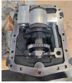
Fig. 14 – Silent pump Pompa silenziata
