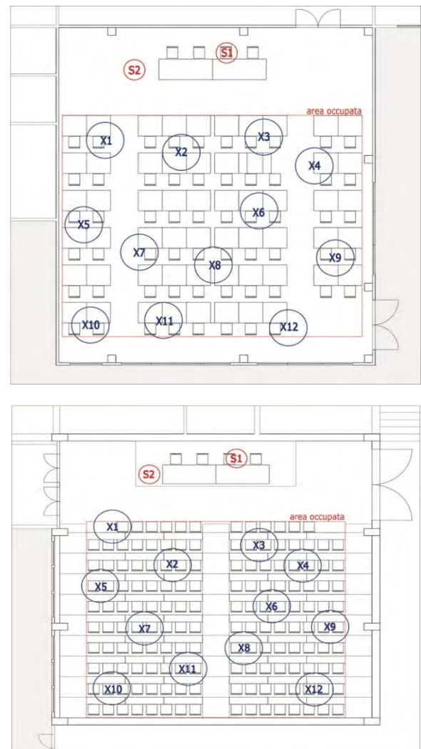
Fig. 3 – Posizioni di sorgente (S) e microfono (X) per la misura del tempo di riverberazione in aula T2 (in alto) e in aula IE (in basso) Positions of source (S) and microphone (X) for the measurement of reverberation time in room T2 (top) and room IE (bottom)
