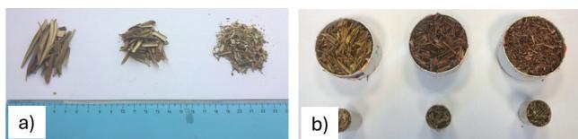
**Fig. 4 – Esempi di scarti di olivo impiegati come matrice a); campioni con scarti legati con una soluzione a base di chitosano b)**
