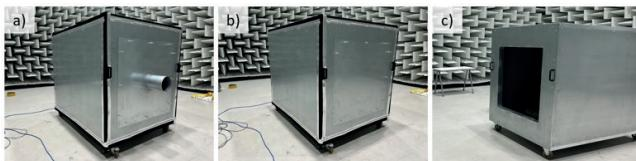
**Fig. 8 – Cabinato industriale oggetto dei test: configurazione con a) camino, b) lamiera, c) apertura**
