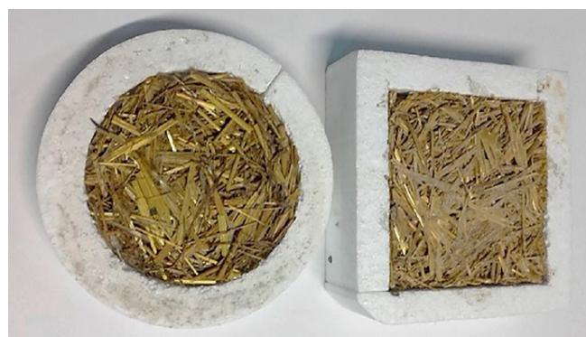
**Fig. 3 – Materiali a base di paglia di orzo e silicato di sodio
