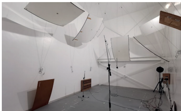
Fig. 4 – Veduta interna della nuova camera riverberante del Laboratorio
