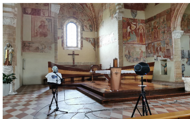
Fig. 7 – Tipico setup di misura per acquisizione della risposta all'impulso in ambiente chiuso
