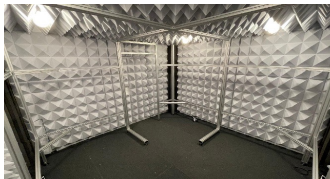
Fig. 4 – Cabina audiometrica con telaio in acciaio Audiometric booth with steel frame
