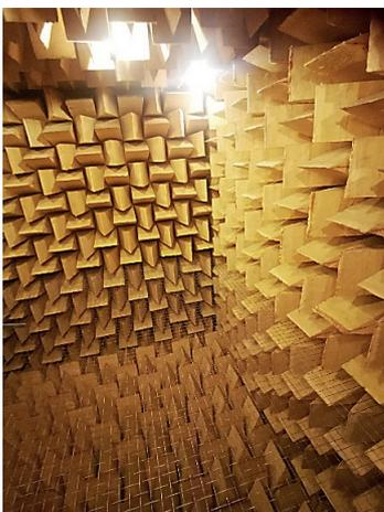
**Fig. 6 – Camera anecoica della MARCO SpA (Castenedolo, BS) impiegata per le misurazioni**
