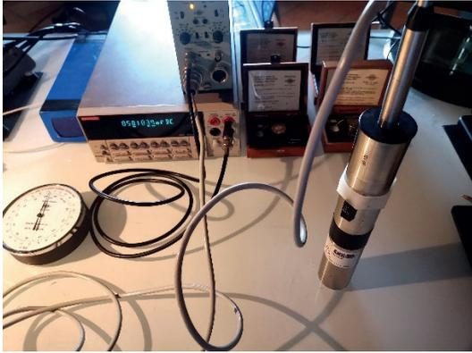
**Fig. 4 – Sistema per la calibrazione dei microfoni**
