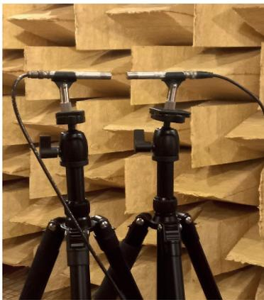
**Fig. 8 – Configurazione dei due microfoni affacciati tra loro collocati al centro della camera anecoica**
