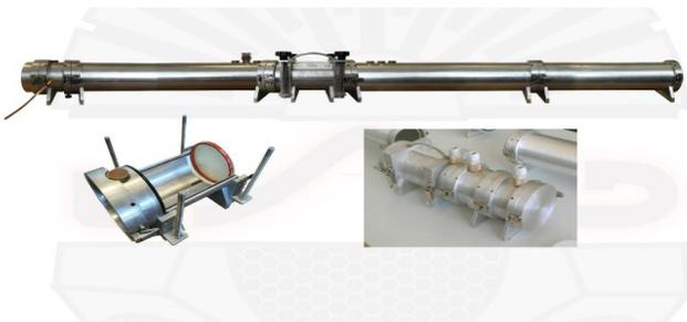
**Fig. 9 – Tubo ad onde stazionarie adattato per la misura della resistività al flusso d'aria e le misure a bassa frequenza**
