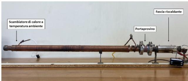
**Fig. 11 – Prototipo di dispositivo termoacustico**
