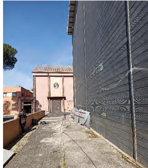
**Fig. 6 – Misura di isolamento acustico di facciata ante operam**
