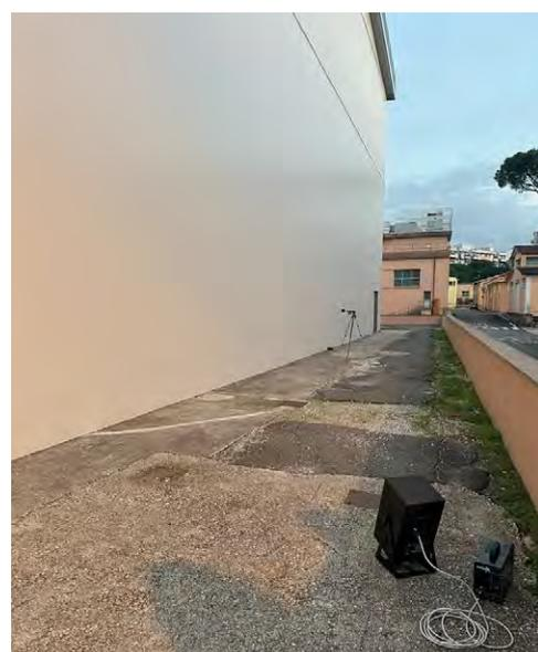
**Fig. 7 – Misura di isolamento acustico di facciata post operam**
