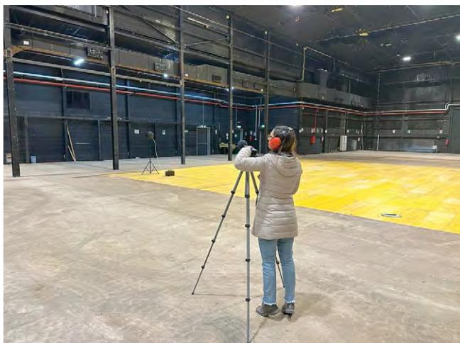
**Fig. 8 – Misura di tempo di riverberazione**
