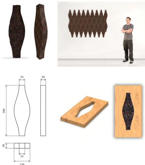
**Fig. 10 – Prototipo di pannello modulare**
