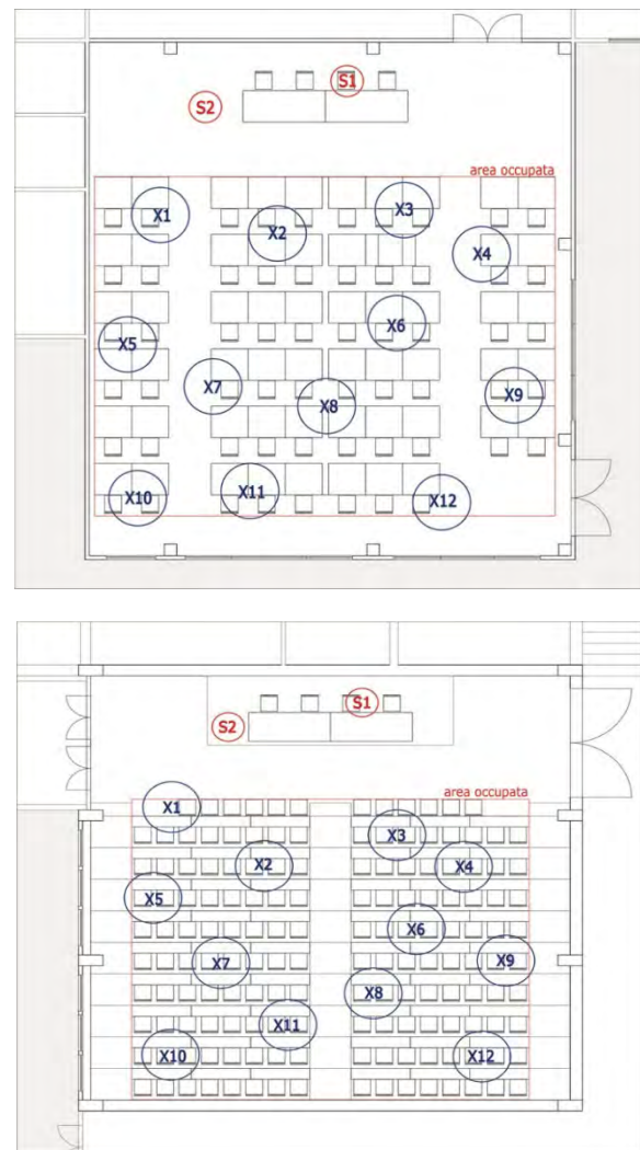
Fig. 3 – Posizioni di sorgente (S) e microfono (X) per la misura del tempo di riverberazione in aula T2 (in alto) e in aula IE (in basso) Positions of source (S) and microphone (X) for the measurement of reverberation time in room T2 (top) and room IE (bottom)
