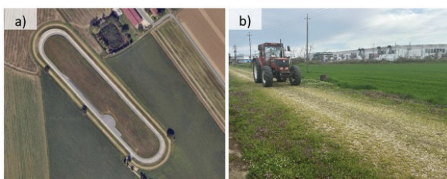
Fig. 4 – Contesti delle prove con trattore in condizioni di guida: a) pista asfaltata, b) strada sterrata Testing contexts for tractor under driving conditions: a) asphalt track, b) unpaved road
