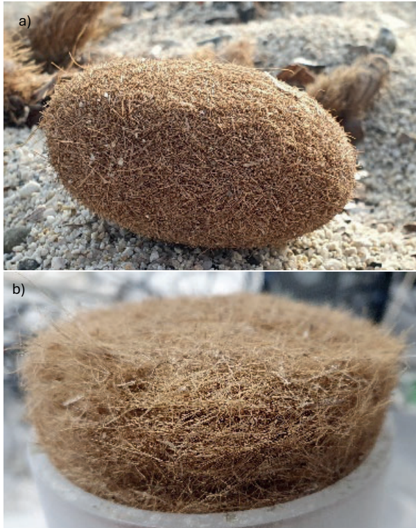
Fig. 6 – Posidonia oceanica fibres: a) Aegagropiles deposited on the beach by the sea; b) Fibrous sample tested in the laboratory Fibre di Posidonia oceanica: a) Egagropili depositate dal mare sulla spiaggia; b) campione fibroso testato in laboratorio
