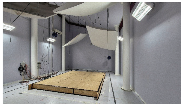
Fig. 2 – Testing sample installed into the reverberant chamber Camera riverberante con campione di prova installato
