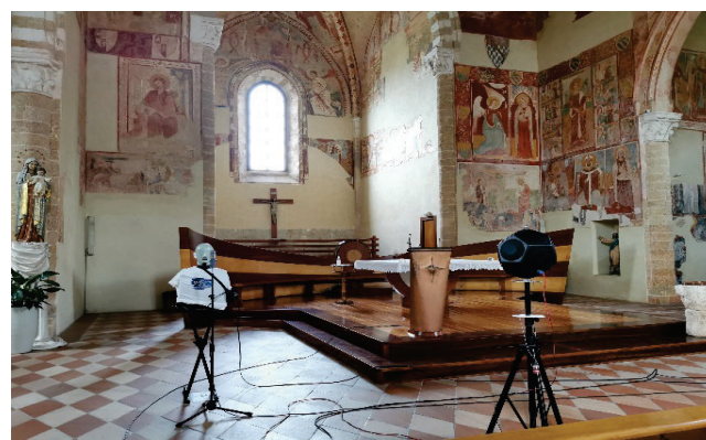
Fig. 7 – Tipico setup di misura per acquisizione della risposta all'impulso in ambiente chiuso Typical measurement setup for impulse response acquisition in indoor environment
