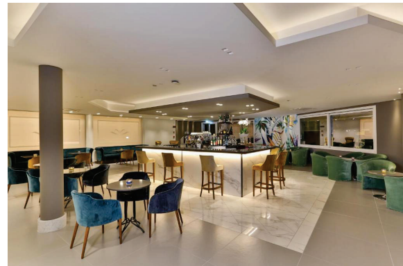
Fig. 1 – Configurazione spaziale e arredi che causavano un eccessivo tempo di riverberazione
