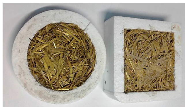
Fig. 3 – Materiali a base di paglia di orzo e silicato di sodio Straw based materials obtained using sodium silicate solution as binder
