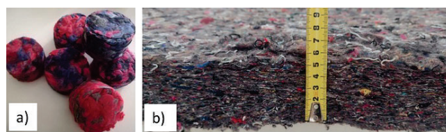
Fig. 1 – Materiali a base di scarti tessili ottenuti con la tecnica ad incollaggio chimico a), e con il processo air-laying b) Textile waste materials obtained following the chemical binding method a), and the air-laying technique b)
