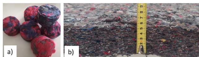
**Fig. 1 – Materiali a base di scarti tessili ottenuti con la tecnica ad incollaggio chimico a), e con il processo air-laying b) Textile waste materials obtained following the chemical binding method a), and the air-laying technique b)**
