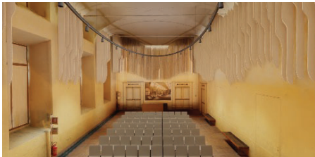
Fig. 4 – Second designed solution with parametric baffles Seconda proposta progettuale parametrica con pannelli fonoas-sorbenti sospesi
