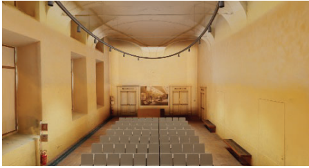
Fig. 3 – First designed solution with plastered absorbing panels Prima proposta progettuale con pannelli fonoassorbenti rivestiti d'intonaco
