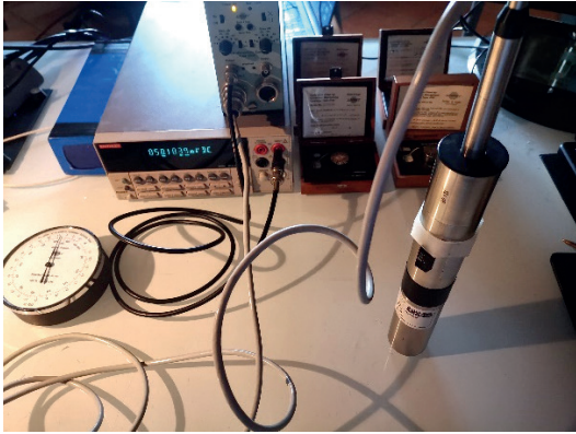
Fig. 4 – Sistema per la calibrazione dei microfoni System used for microphone calibration
