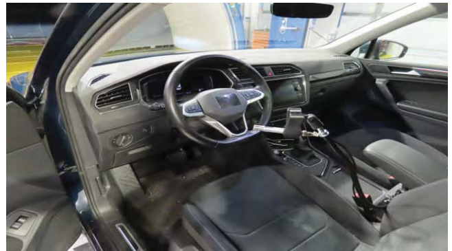
Fig. 12 – Diffuse field microphone installation inside the car Installazione microfono a campo diffuso all'interno della vettura
