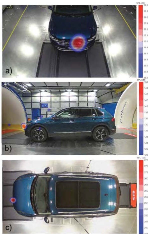
Fig. 22 – Frontal (a), lateral (b) and overhead (c) array coherent sound map for the 2500 Hz one-third octave band Mappa acustica coerente dell'array frontale (a), laterale (b) e superiore (b) per il terzo di ottava 2500 Hz
