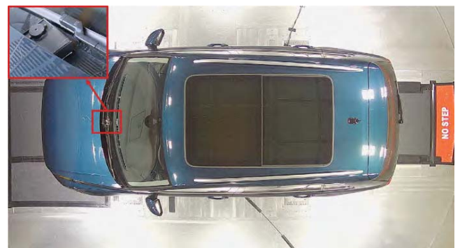
Fig. 13 – KingState KPE-141 noise generator installation Installazione della sorgente acustica KingState LPE-141
