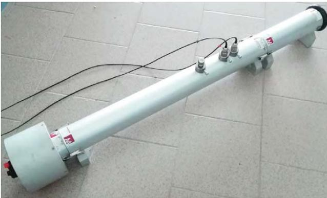
**Fig. 9 – Apparato di misura del coefficiente di assorbimento acustico ad incidenza normale e modalità di montaggio del campione**
