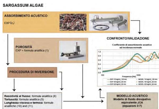
**Fig. 8 – Schema del processo di caratterizzazione e modellazione acustica**
