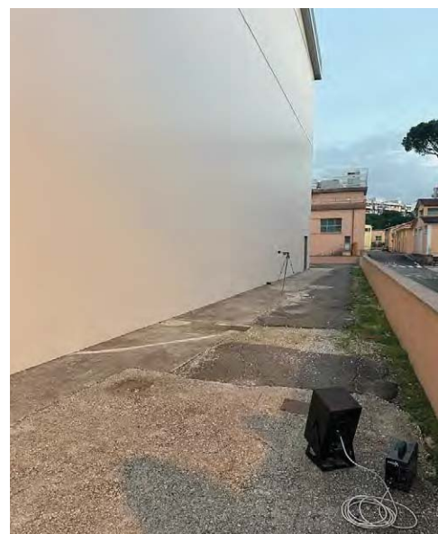
Fig. 7 – Misura di isolamento acustico di facciata post operam Façade sound insulation measurement post operam
