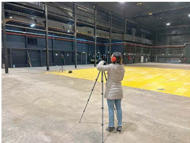
Fig. 8 – Misura di tempo di riverberazione Reverberation time measurement
