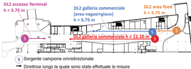
Fig. 7 – Schema planimetrico con indicazione delle postazioni individuate per la sorgente campione e le direttrici lungo le quali sono state effettuate le misure fonometriche Layout showing the positions of the sample sources and the directions along which the SPL measurements were carried out
